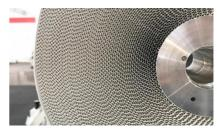
Die Alufolie ist chemisch entfettet und beidseitig mit einer neuen hygroskopischen Rezeptur und einem Primer als Korrosionsschutz lackiert. Die Rezeptur wird mittels Bandbeschichtung aufgebracht. Ein weiterer Vorteil ist die Reduzierung der Durchflussmenge des Kältemittels, was ebenfalls zu einem höheren Wirkungsgrad des Rotors beiträgt.
